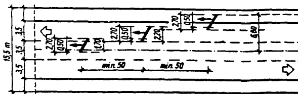
Rys. 3. Schemat pracy zespołu trzech pługów na drodze trójpasowej dwukierunkowej
